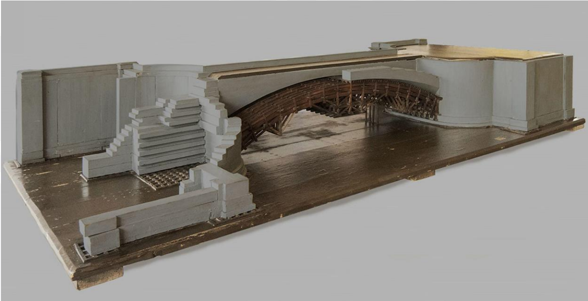
Modello ligneo scomponibile del ponte Mosca sulla Dora riparia, s.d., scala 1:50. Politecnico di Torino, DISEG, Collezione Curioni, Curioni_Modelli_PonteMosca:
